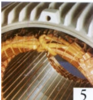
Corto en la conexión
