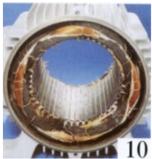
Falla se fase (conectado en estrella)
