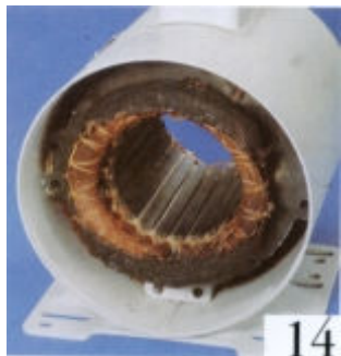
Quema en la bobina principal
