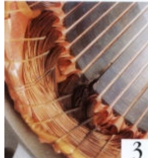
Corto contra masa en la salida de la ranura
