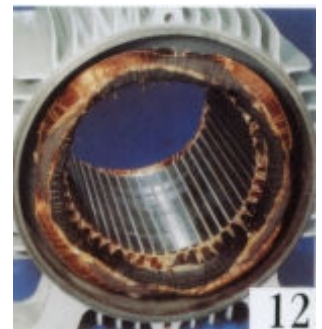
Fase dañada por desbalanceo de tensión de la red
