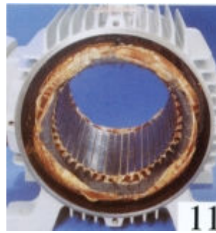
Falla se fase (conectado en triangulo)
